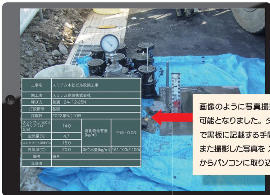
画像のように写真撮影と共に黑板に試験結果を表示させることが可能となりました。タブレットが黑板の代わりになるため、現場で黑板に記載する手間が省略できます。また撮影した写真を XL-Q に取り込むことができるため、デジカメからパソコンに取り込む手間も省略できます。
